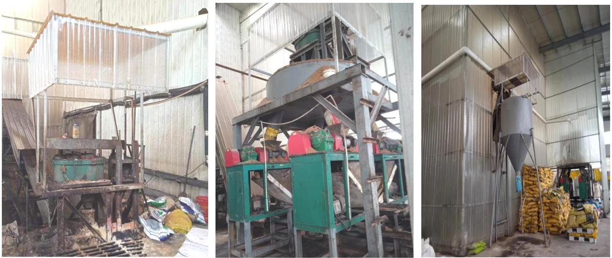
固体颗粒生产线（挤压造粒生产线）
